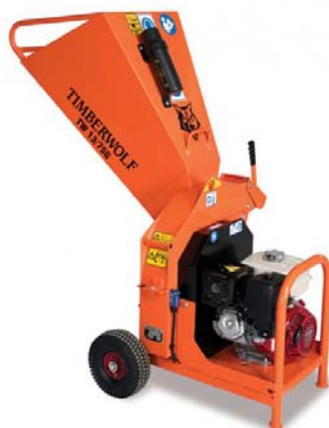
Рис. 3. Тріскоріз «TW 13 / 75G CHIPPER» англійської компанії «TimberWolf»
