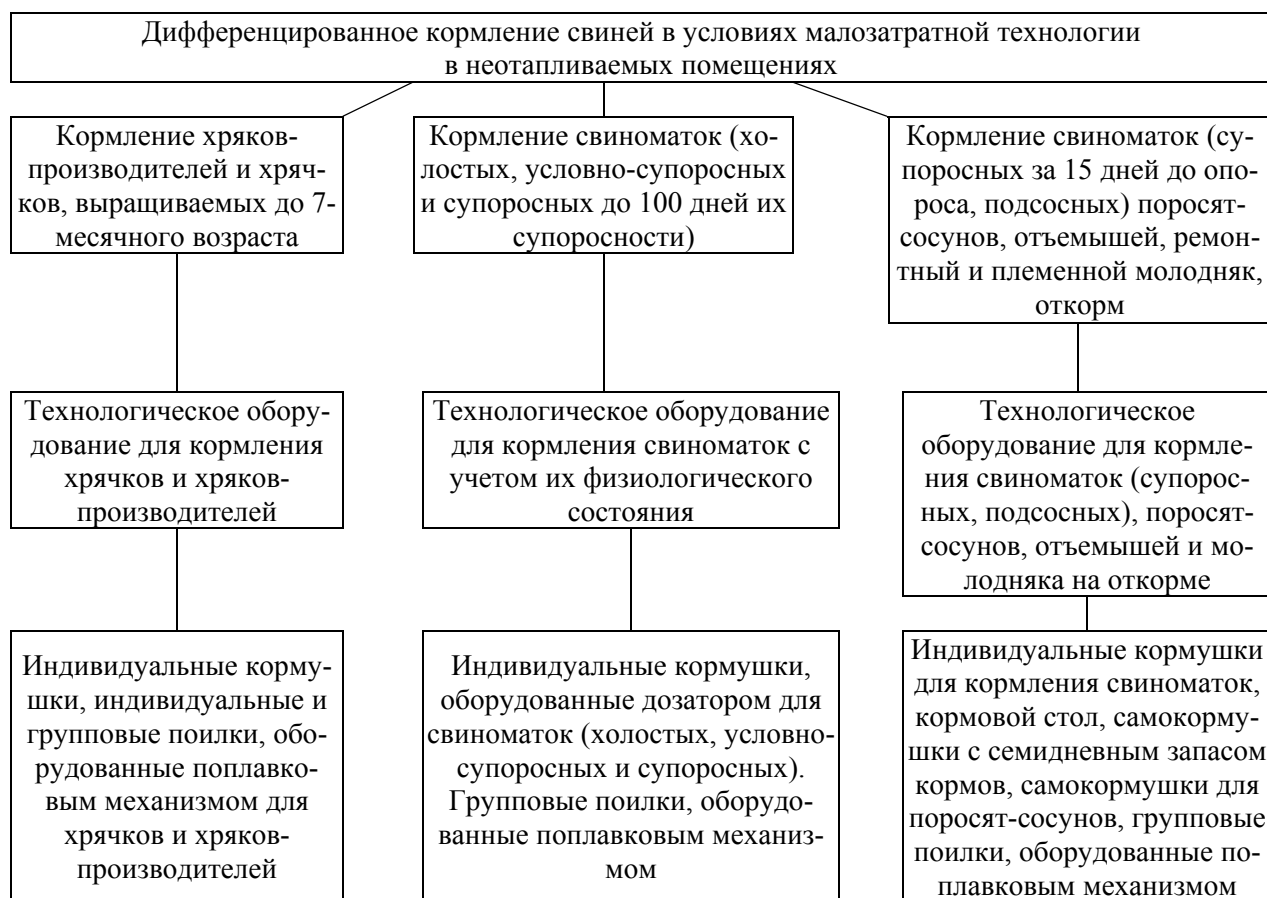
Рис. 2. Схема размещения технологического оборудования для дифференцированного кормления свиней в условиях однофазного их содержания в неотапливаемых помещениях
