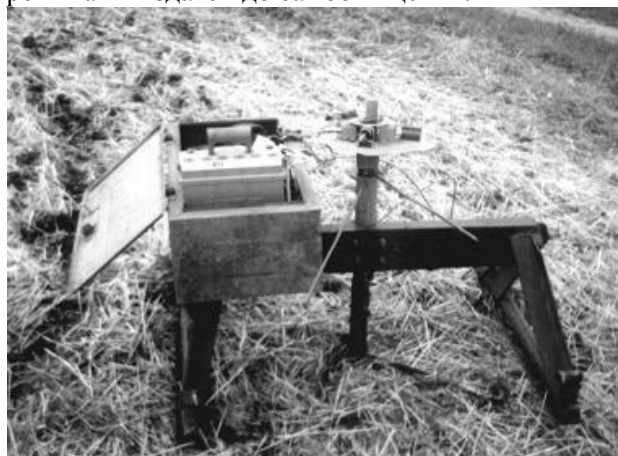
Рис. Польова установка для дослідження технічних характеристик ґрунтообробного робочого органу з обмеженим вільно-обертливим рухом у горизонтальній площині
