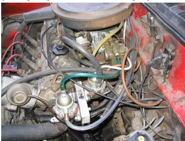
Рис. 1. Двигун МеМЗ-245 на автомобілі ЗАЗ-1102 “Таврія”
