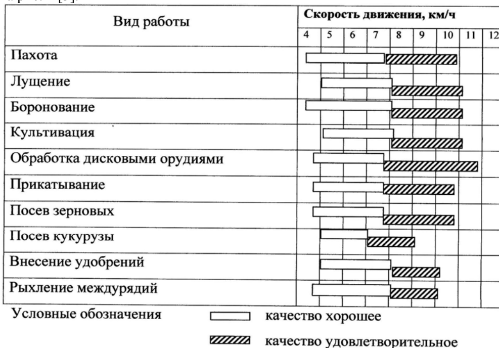
Рис. 1. Изменение качества выполняемых сельскохозяйственных работ в зависимости от скорости движения агрегата
