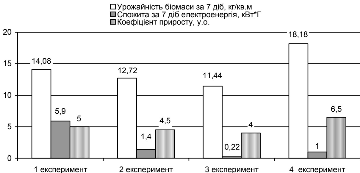
Рис. 3. Вплив умов освітлення вегетаційної поверхні та передпосівної біостимуляції насіння "Гумісолом" на урожайність гідропонного корму, коефіцієнт його приросту та кількість спожитої електроенергії (1 – люмінесцентний 32 Вт/м 2 ; 2 – люмінесцентний 16 Вт/м 2 ; 3 – імпульсний; 4 – імпульсно-люмінесцентний 8 Вт/м 2 )
