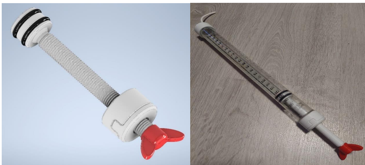
а) б) а – цифрова 3D-модель; б – фотографічне зображення Рисунок 1 – Пневмокамера з поршневим нагнітачем.
