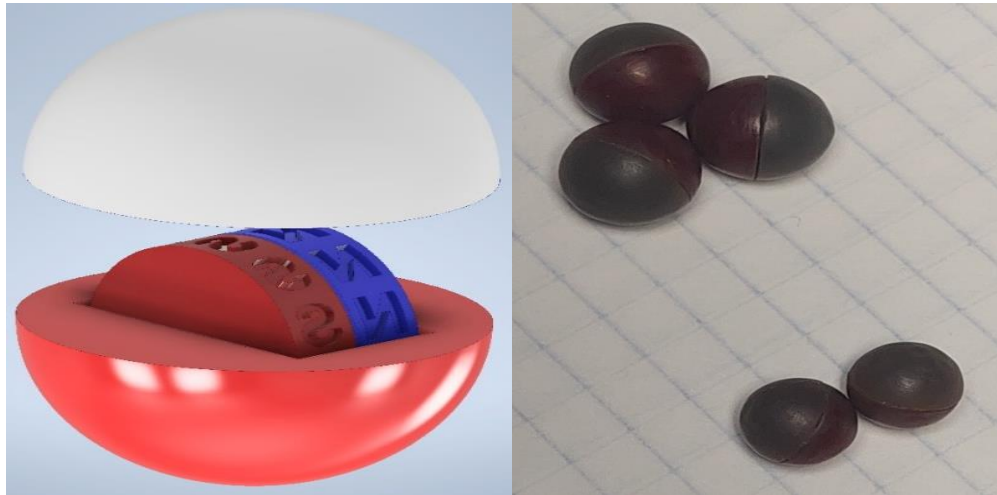
а) б) а – цифрова 3D-модель; б – фотографічне зображення Рисунок 2 – Кулеподібний занурюваний елемент.
