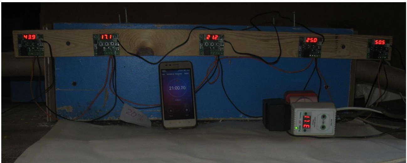
Рисунок 2 – Проведення досліджень процесу нагріву зерна контактним способом на експериментальній установці
