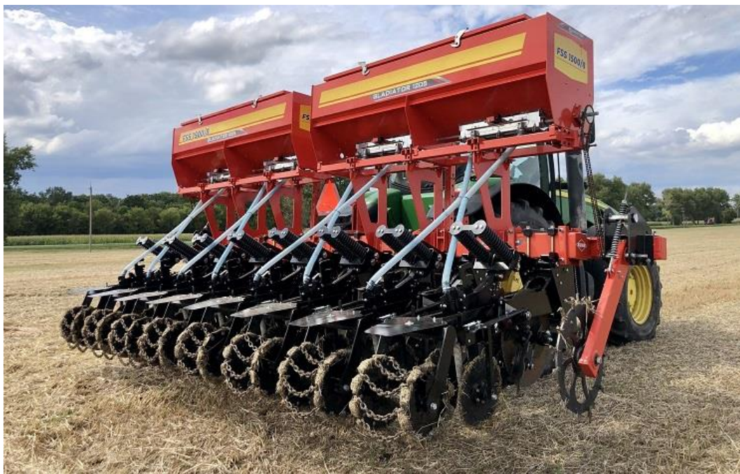
Рис. 2 – Агрегат смугового обробітку ґрунту KUNH Gladiator
