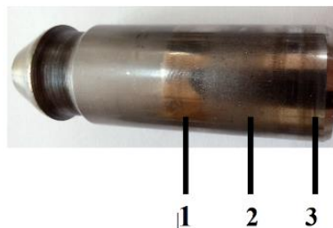
Рисунок 1 – Плунжер клапана КН 50.16 У1 з прийнятими для вимірювання поясами 1,2,3 в зоні максимального зносу
