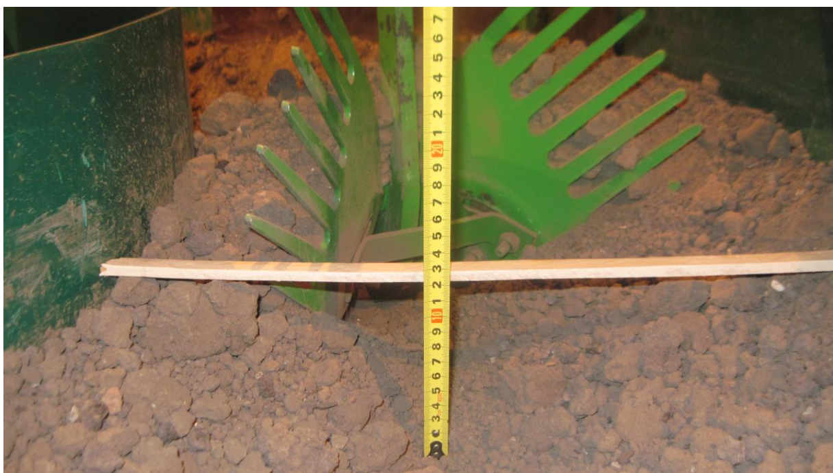
Рисунок 2.4 – Визначення глибини розвальної борозни в умовах лабораторної установки
