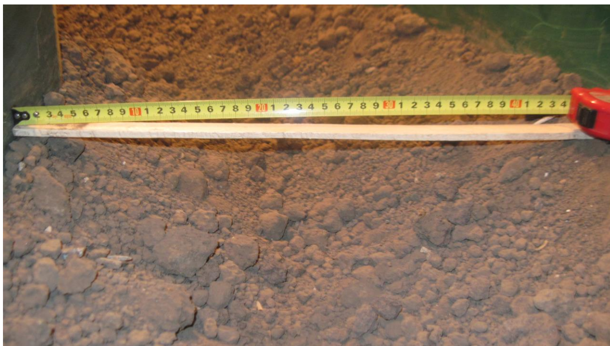
Рисунок 2.5 – До методики визначення ширини розвальної борозни в ґрунтовому каналі для лабораторних випробувань
