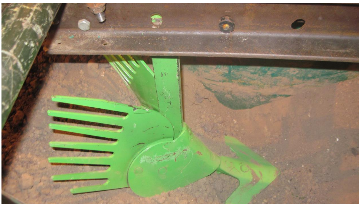
Рисунок 2.2 – Робочий орган для рядкового пригортання картоплі.
