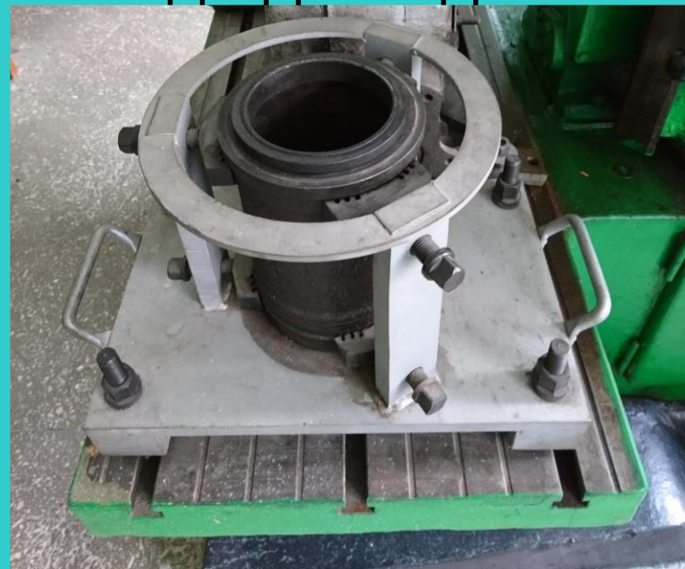
Пристосування для фіксування гільзи циліндра
