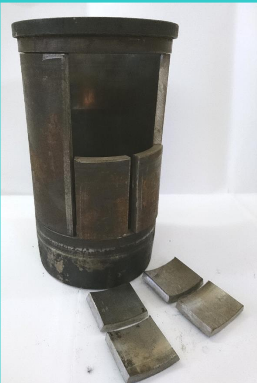
Заготівки вирізані із досліджуваної гільзи
