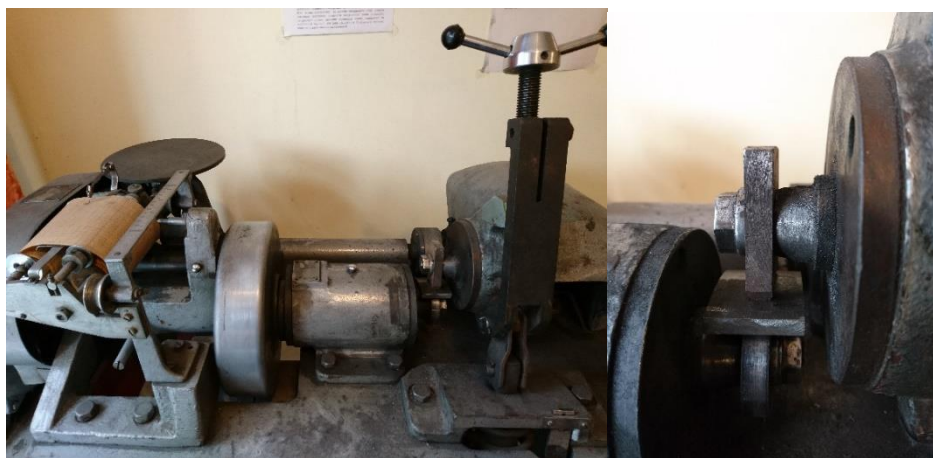
Рисунок 1. – Машина тертя МІ – 1М (машина Амслера). Загальний вигляд. Джерело: фото авторів як продовження власних досліджень
