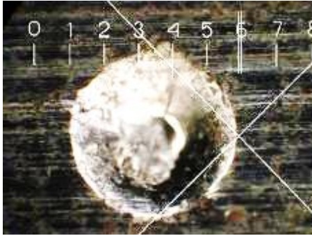
Рис. 1. Характер відбитків на зразках відновлених розточуванням з послідуєчим хонінгуванням та гартуванням: ( \times 130 , в зворотному світлі)
