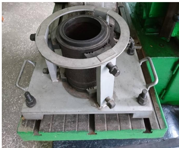
Рисунок 2. – Пристосування для центрування гільз циліндрів на станині верстату
