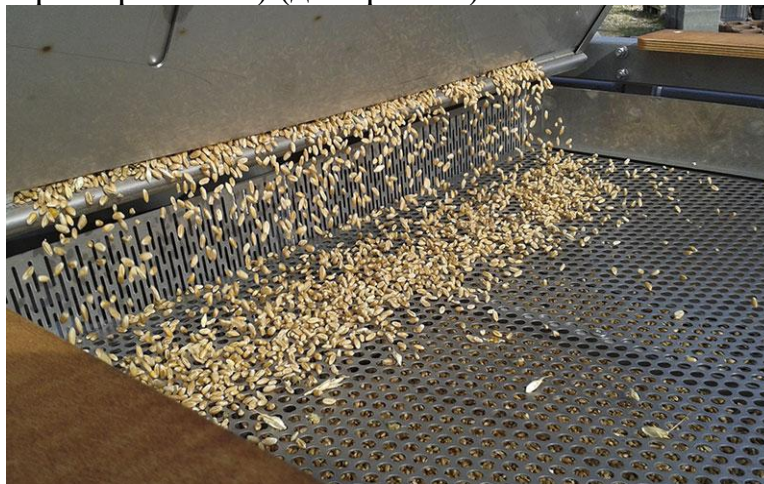
Рисунок 2. – Фото сита для очищення зерна На машині із ситами, урожай відбирається за розмірами та формою.
