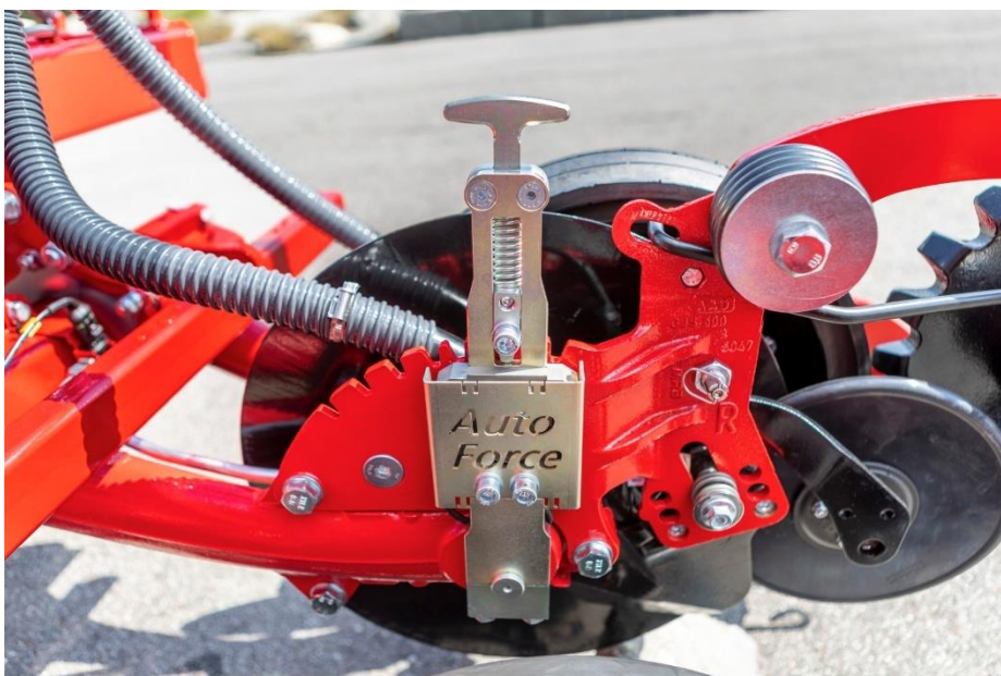
Рисунок 1. - Система автоматичного дожиму сошника AutoForce
