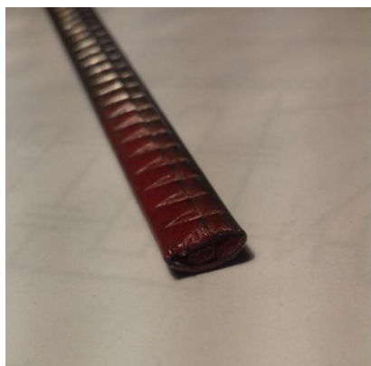
1-шихтовий наповнювач; 2-сталева оболонка; 3- рифлення
