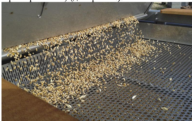
Рисунок 2. – Фото сита для очищення зерна
