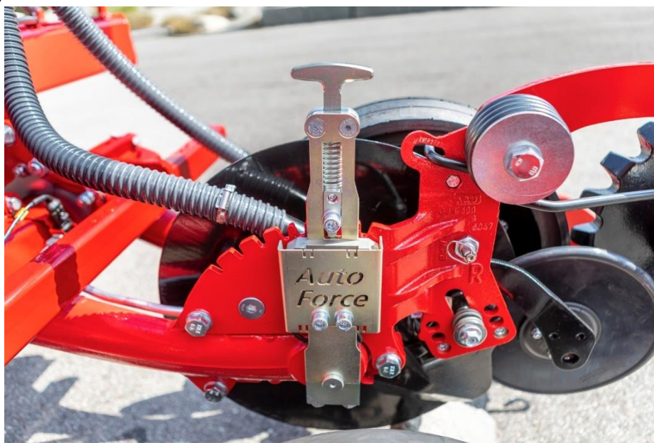
Рисунок 1. - Система автоматичного дожиму сошника AutoForce
