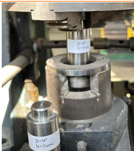
Рисунок 1. – Експериментальне обладнання, яке використовувалось для обґрунтування оптимальних технологічних режимів обробки тиском за допомогою вібрації відносно поверхонь тертя бронзових втулок гідравлічних шестеренних насосів.
