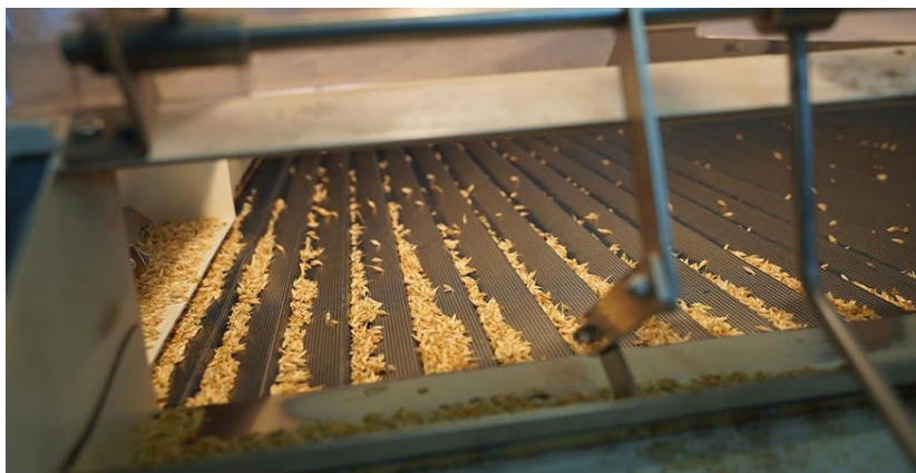
Рисунок 1. – Фото сортувальної гірки для очищення зерна Сито (пристрій з решетом) (див. рис. 2.).
