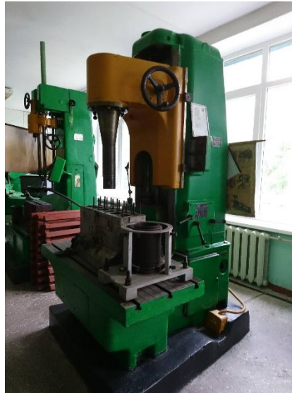
Рисунок 1. – Вертикально-розточувальний верстат 2Е78П (рис. 1.)
