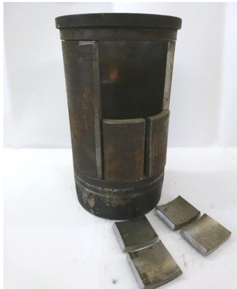
Рисунок 4. – Заготовки вирізані із стандартних гільз і розточених на ремонтний розмір
