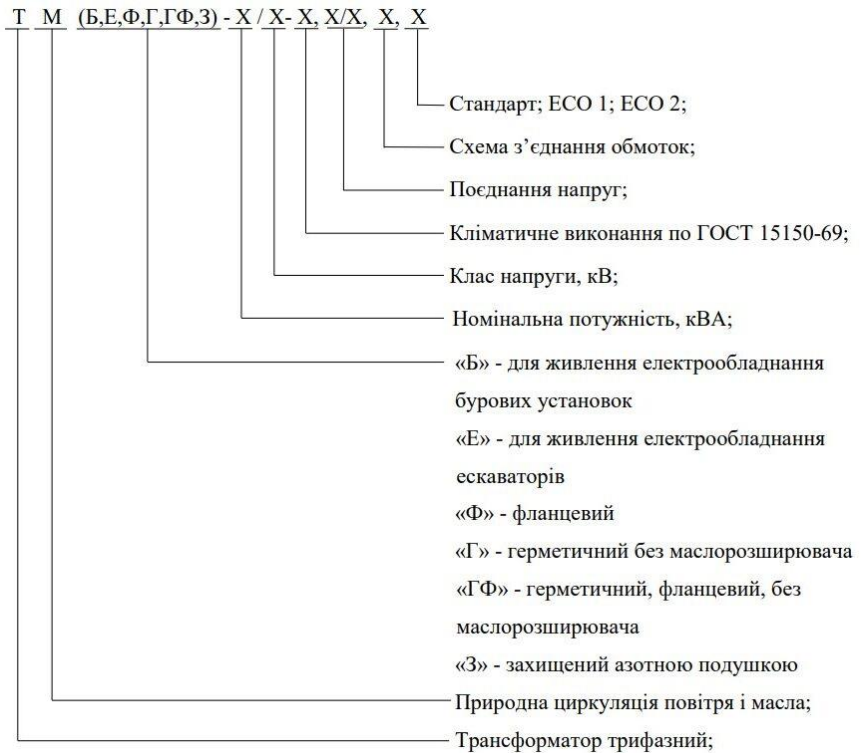
Рисунок 1. Структура умовного позначення типу трансформатора.
