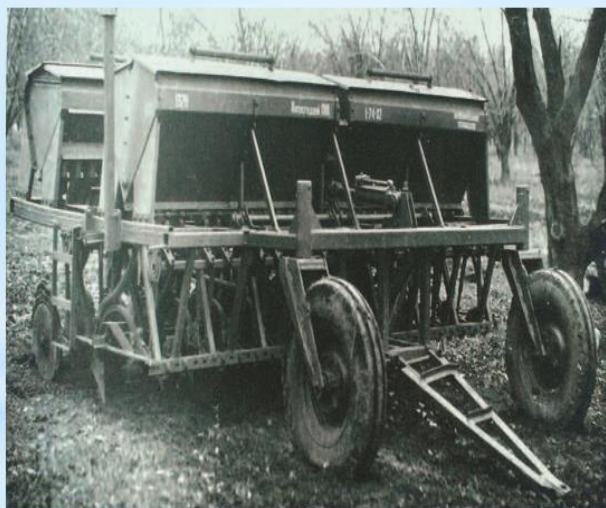
Дослідний зразок комбінованої сівалки СЗК-3,6 із можливостями локального внесення добрив, виготовлений на заводі “Червона Зірка”
