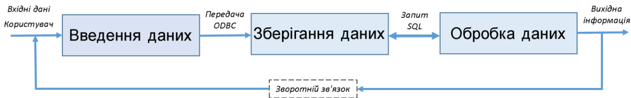
Рисунок 1 – Схема функціонування ІС
