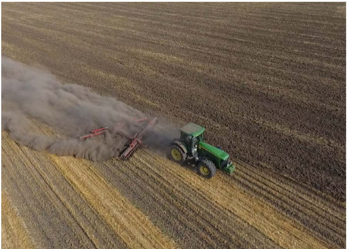
Рис. 2.2. Дискування попередника під посів органічних конопель трактором John Deere 8520 в агрегації з дискатором Kverneland Qualidisc 6000T
