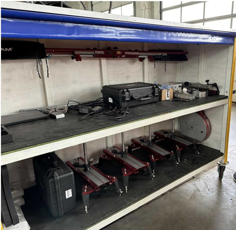
Рисунок 5 – Приклад організації робочих місць з КУКК вантажних автомобілів на великій СТО
