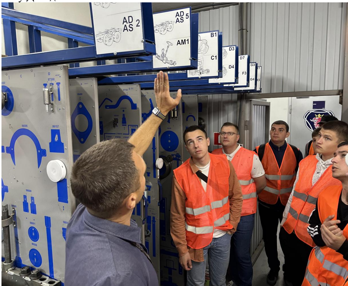
Рисунок 4 - Приклад організації робочих місць для зберігання спеціального інструменту на великій СТО для вантажних автомобілів
