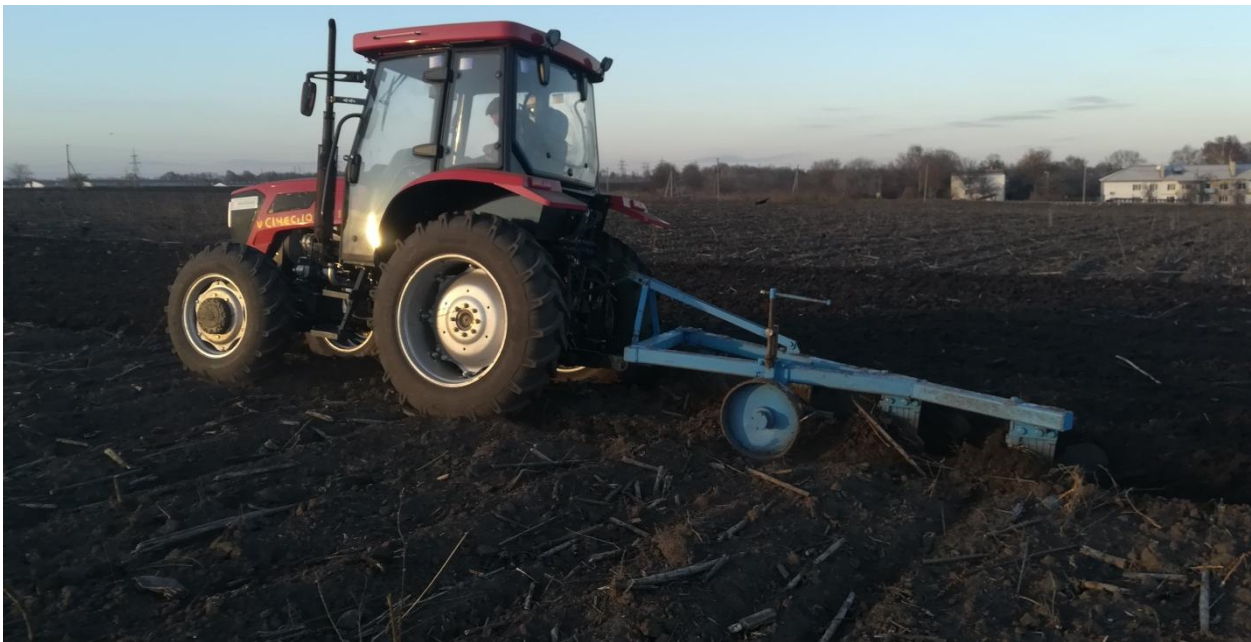
Рисунок – Трактор Січеслав-1104 на тягових роботах з плугом
