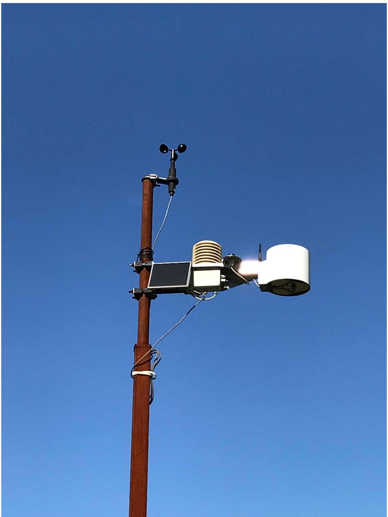
Рис 2. Метеостанція з програмним забезпеченням - Field Climate;
