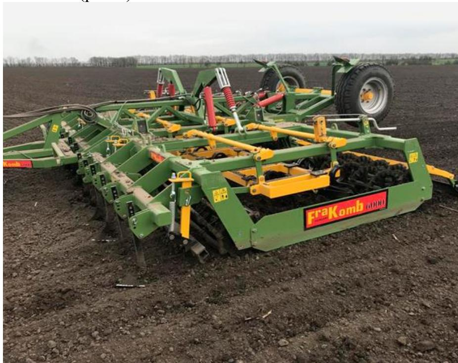
Рис.1 Широкозахватне комбіноване знаряддями, типу FRAMEST FraKomb.
