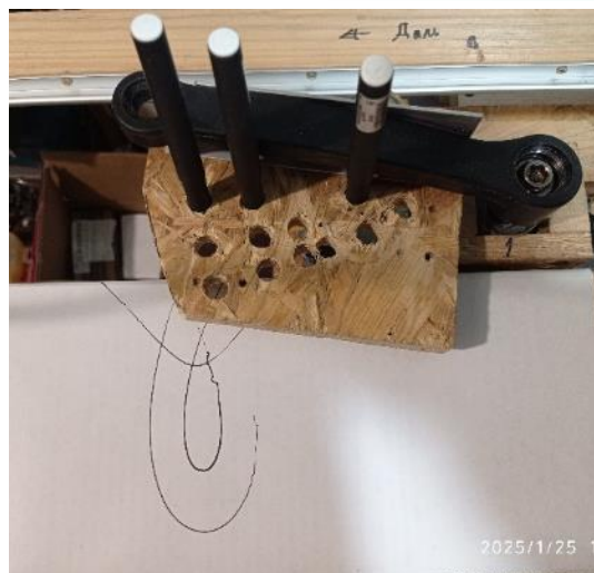
Рисунок 2 – Робочий момент налагодження пульта керування (а) та пишучих вузлів (б) модульного ґрунтового міні-каналу
