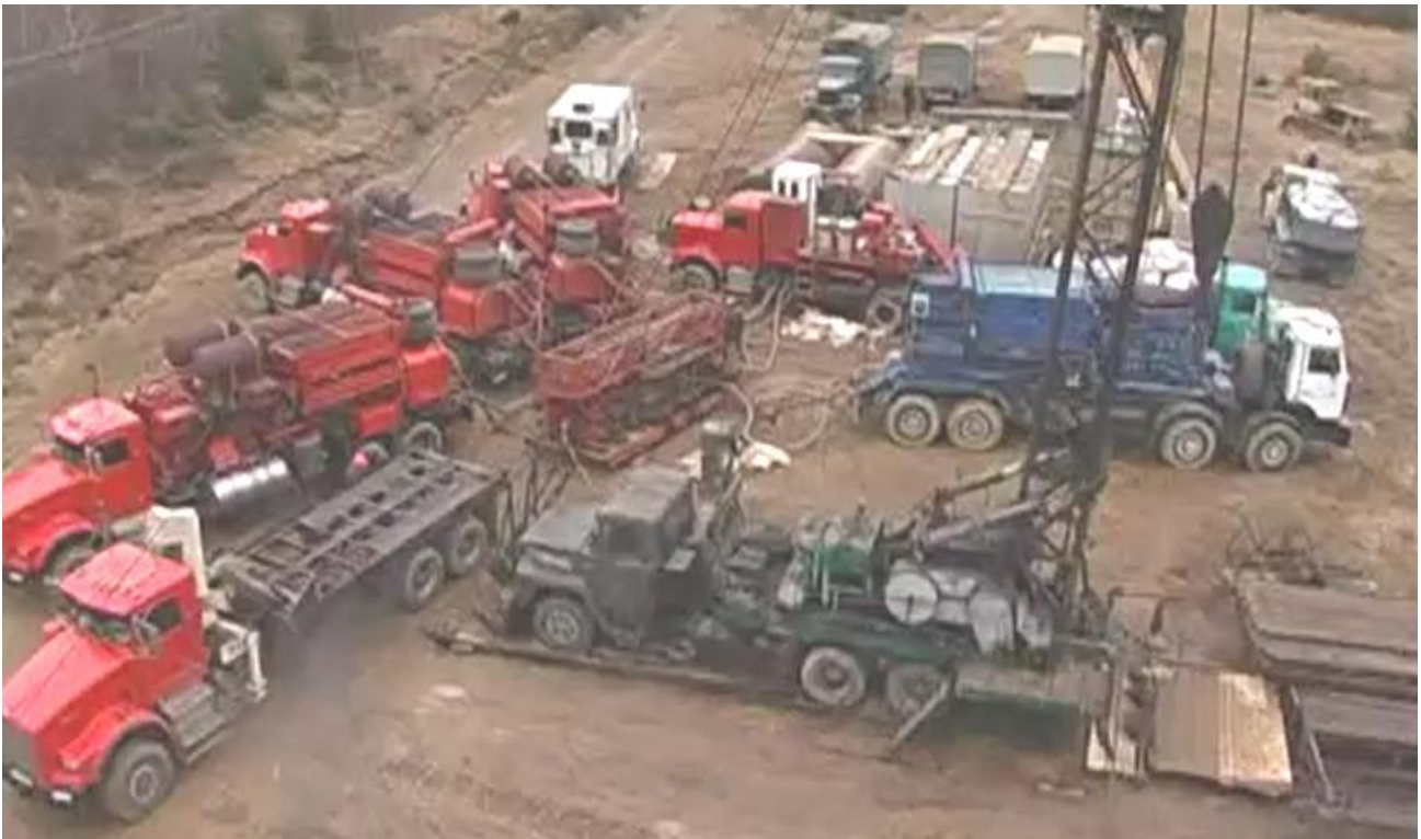
Рисунок 1 – Проведення випробовувань на базі мобільного агрегату для гідророзриву пластів мод. Halliburton Tier IV DGB на шасі Мерседес 4150 (8×8)
