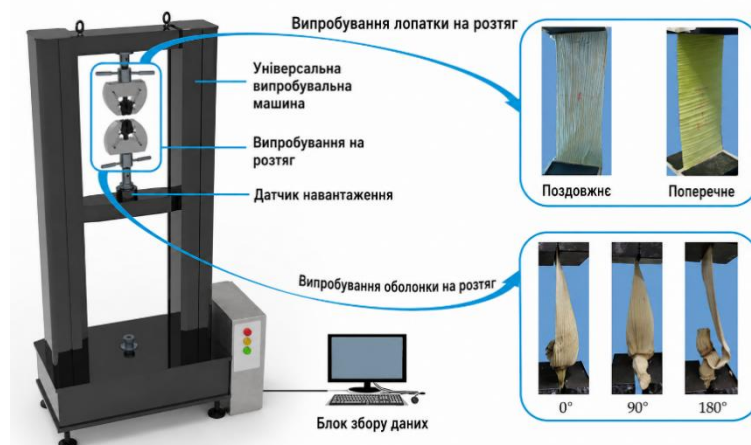
Рис.2. Установка для випробування на розтяг
