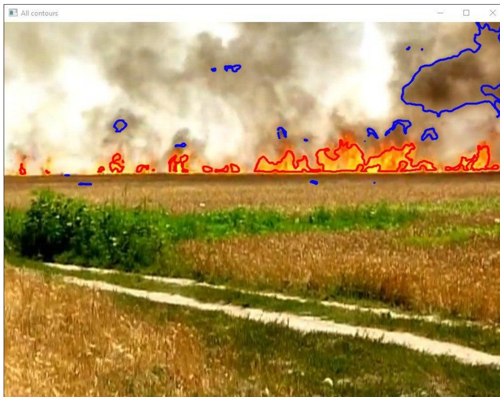
Рисунок 1 – Приклад роботи розробленого алгоритму із виявлення диму та полум'я
