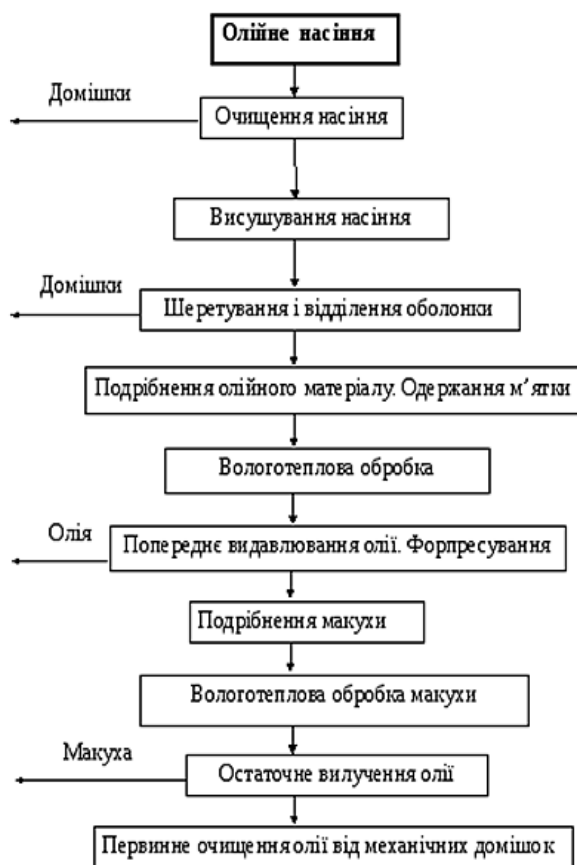
Рисунок 2 – Схема вилучення рослинної олії пресуванням
