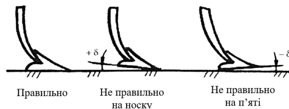
Рисунок 2 – Схеми роботи лап, культиватора з дволанковою підвіскою.
