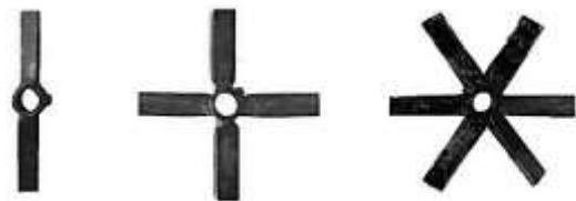
Рисунок 2 – Конструкція робочих органів лабораторної дробарки з трапецієподібною формою лопатей та кутом нахилу профілю 90°
