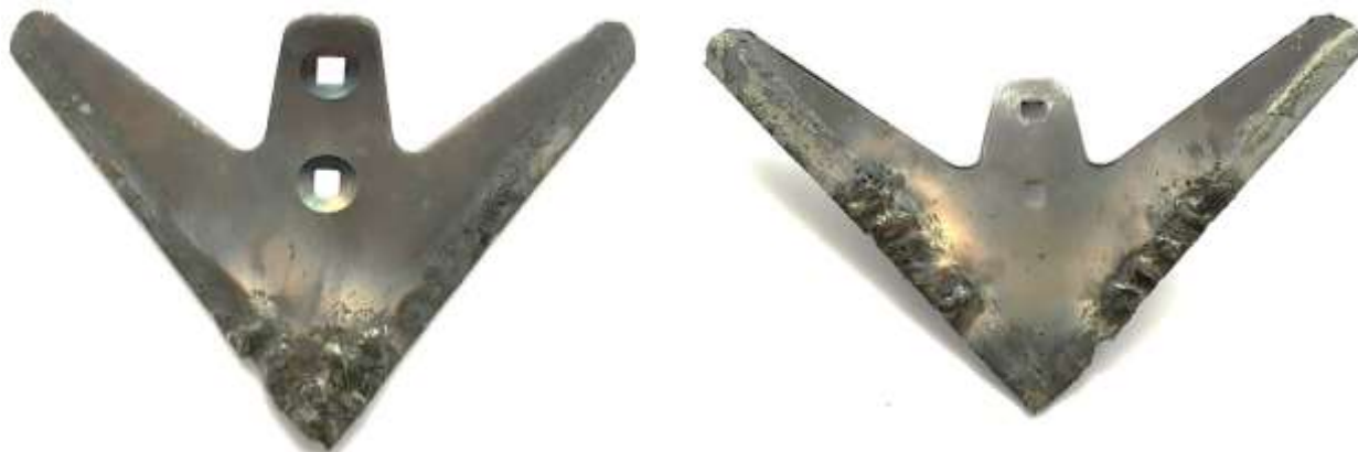
Рисунок 2 – Зовнішній вигляд зміцнюючих смуг, нанесених на культиваторну лапу вітчизняного виробництва: а – носок; б – крила
