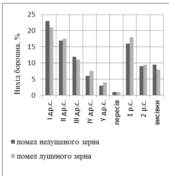
Рисунок 1 – Діаграми виходу та зольності борошна по системах технологічного процесу при переробці лущеного та нелущеного зерна жита
