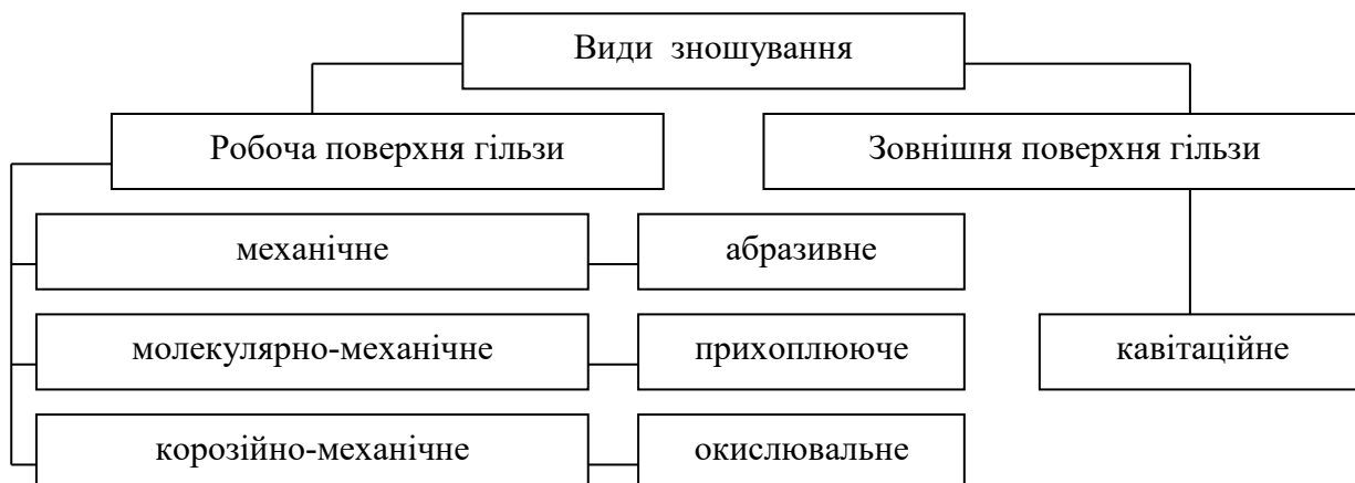
Рисунок 2 – Види зношування гільз циліндрів.
