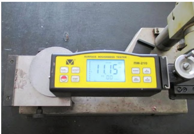
Рис. 3 – Визначення шорсткості дослідних зразків
