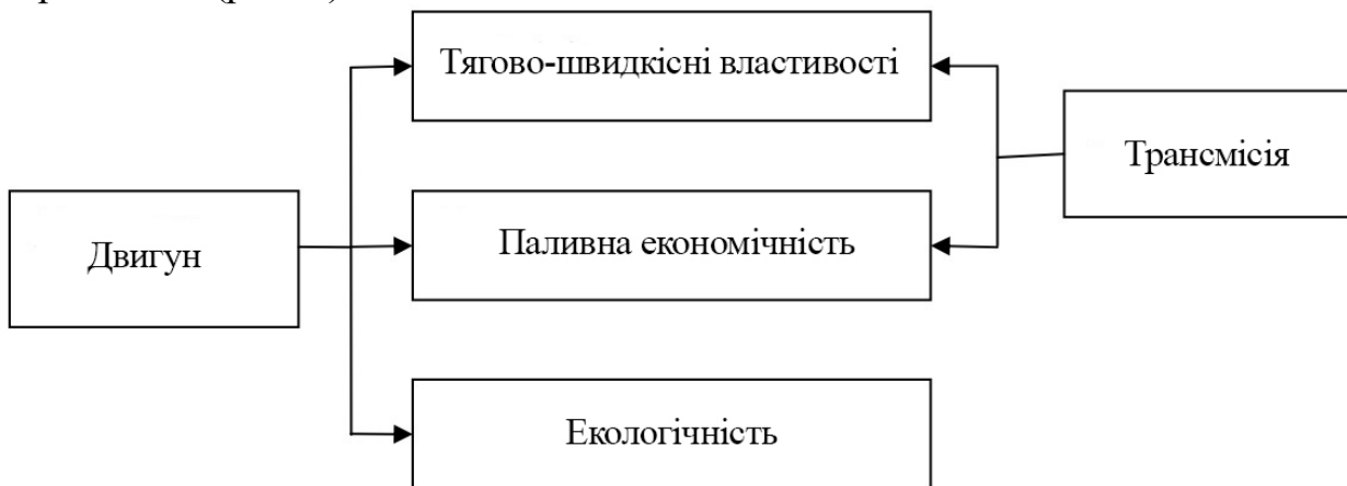
Рисунок 1 – Зв'язок експлуатаційних властивостей з елементами сільськогосподарської машини
