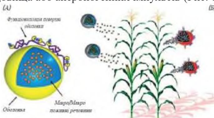
Рис. 1. (А) Модель нанокапсули, що містить макро/мікроелементи; (Б) Приклад відкриття нанокапсули - вивільнення поживних речовин як функція часу, щоб уникнути або обмежити втрати поживних речовин.
