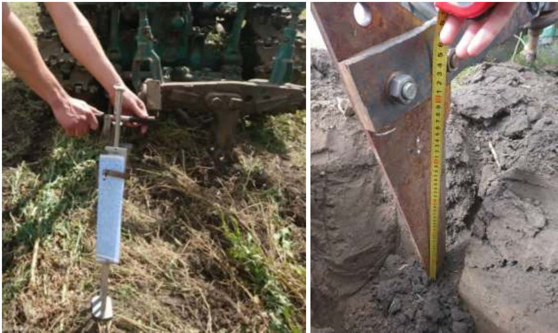
Рисунок 1 – Визначення твердості ґрунту та глибини обробітку в полі
