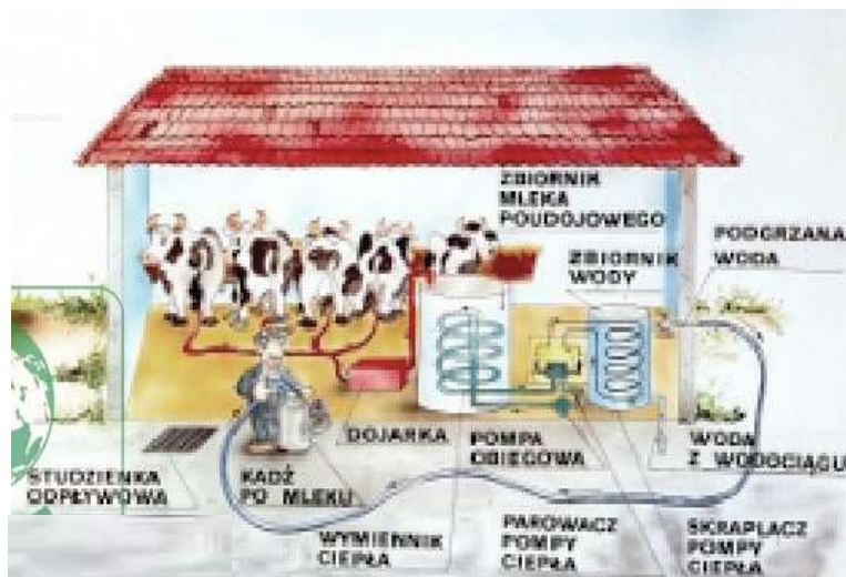
Rys. 1. Instalacja do wykorzystania odpadowego ciepła po chodzeniu mleka
