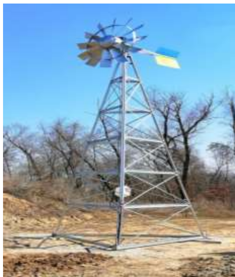
Рис 10. Система для збагачення води ставків киснем
