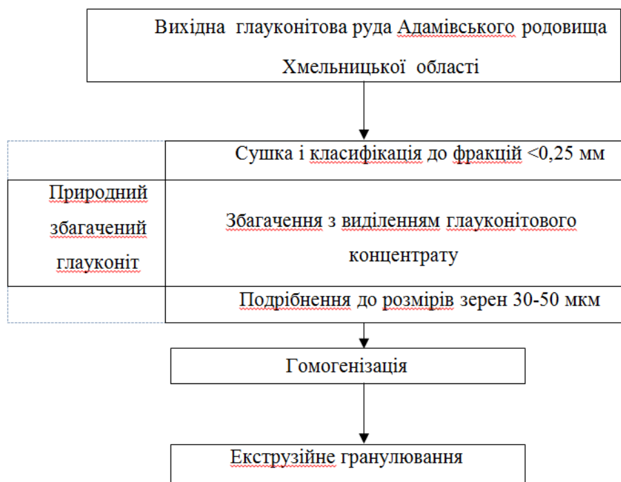
Рис.1. Схема-алгоритм виготовлення гранульованих сорбційних матеріалів з природного глауконіту
