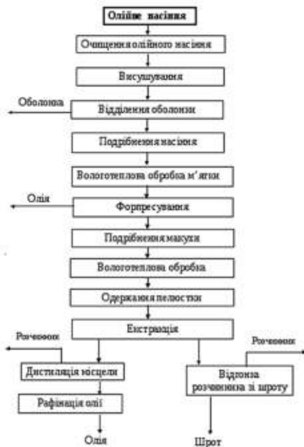
Рисунок 1 – Схема вилучення рослинної олії екстракцією
