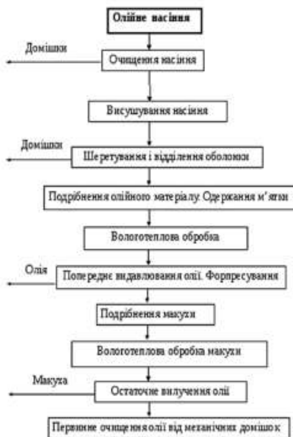
Рисунок 2 – Схема вилучення рослинної олії пресуванням
