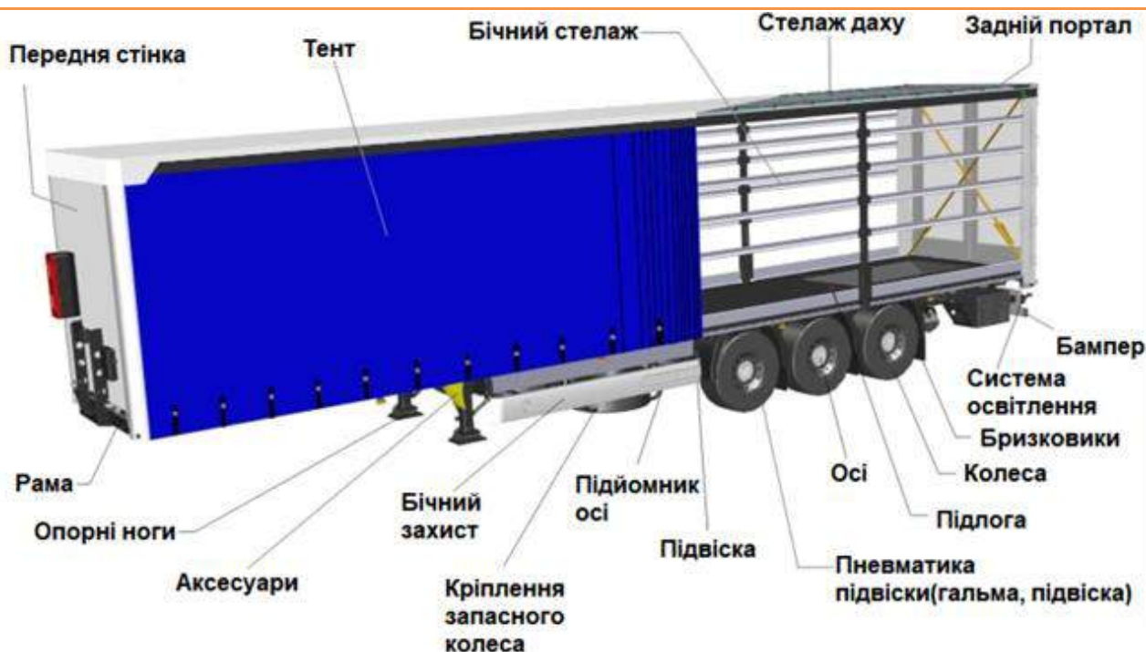
Рисунок 2. – Будова тентового напівпричепи Schmitz Cargobull SCS
