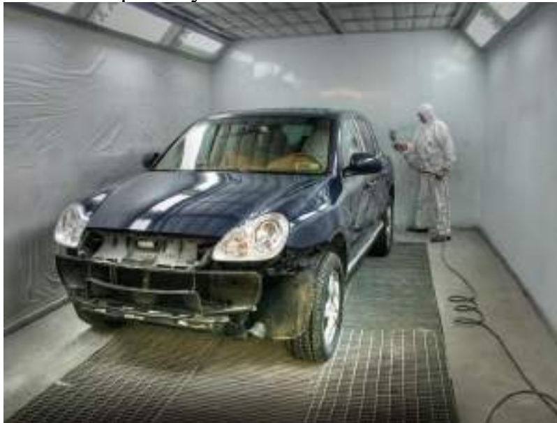
Рисунок 1.4 – Фото фарбувальної камери для відновлення лако-фарбових покриттів автомобіля
