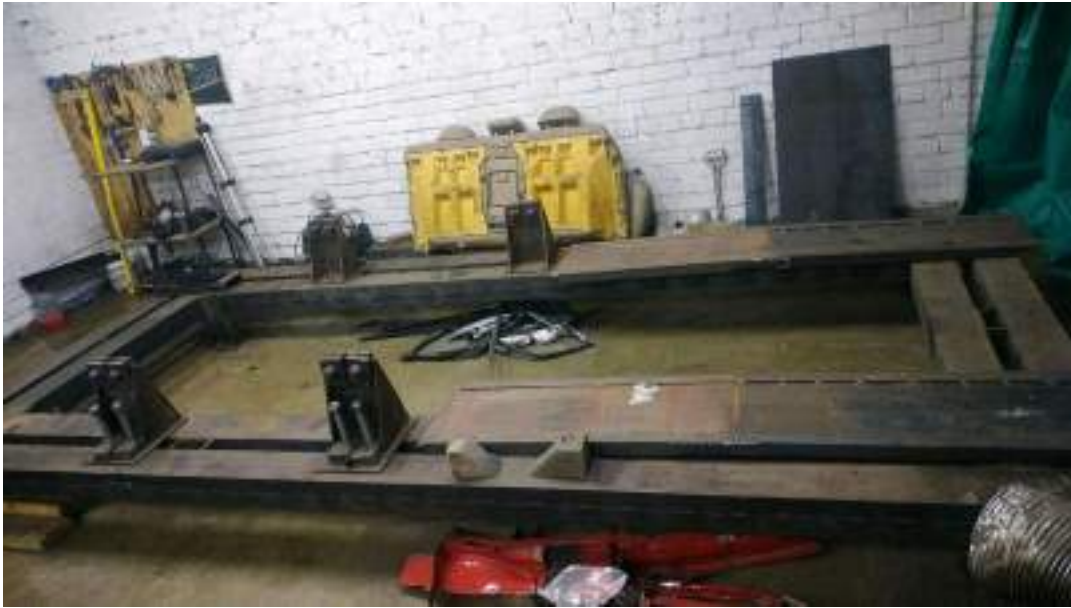
Рисунок 1.3 – Фото стапеля для виконання рихтувально-відновлювальних робіт пов'язаних з геометрією кузовної частини автомобіля
