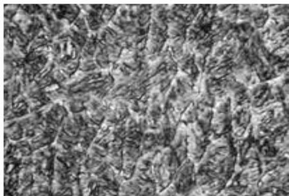
Рисунок 1 - Мікроструктура нарощеного на поверхню шару
