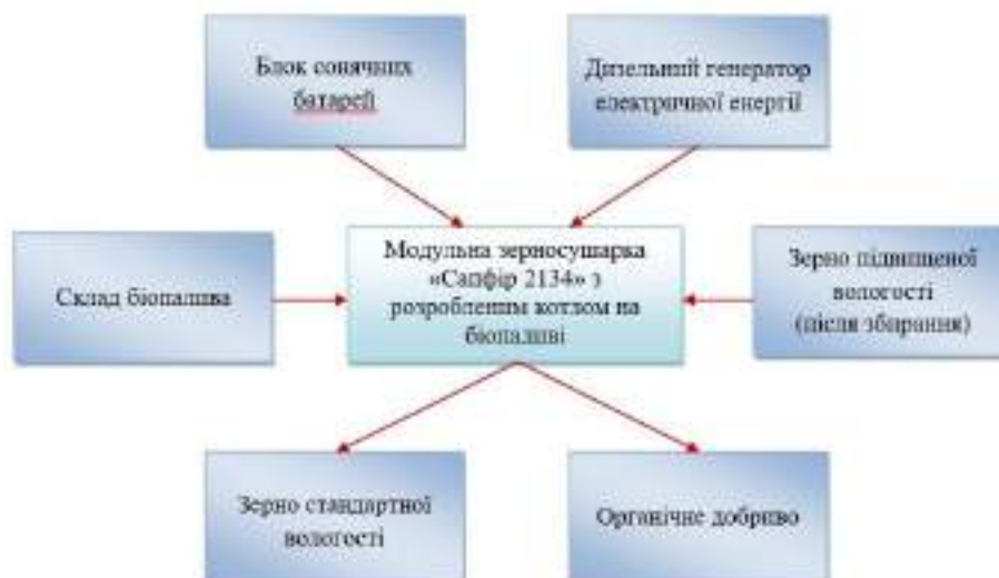
Рис.1 Схема технології сушіння зерна з використанням альтернативних джерел енергії
