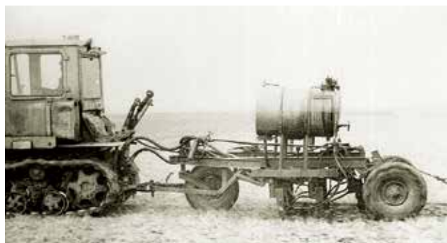
Випробування пристрою для внесення РКД, запропонованого вченими для підживлення сільгоспкультур
