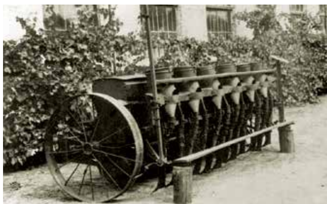
Комбінована сіялка СЗК-3,6, яку застосовували на полях навчгоспу для сівби зернових культур з одночасним внесенням мінеральних добрив
